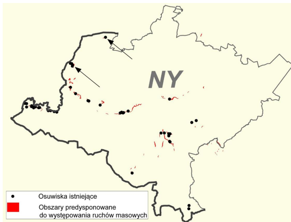
Rysunek 14. Obszary o możliwości rozwoju ruchów masowych na terenie powiatu nyskiego (ze wskazaniem obszarów wyznaczonych na terenie Gminy Kamiennik)
